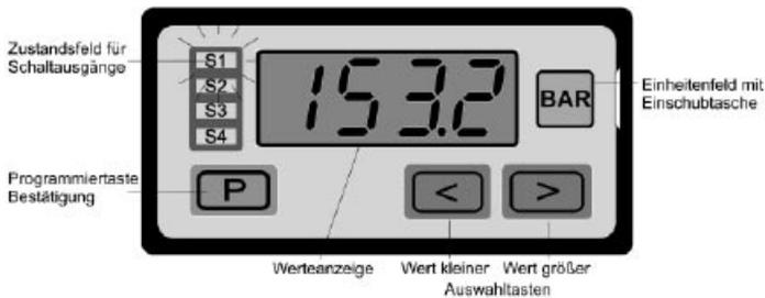
Schiebeschalter "SS1" zur Parametereinstellung auf "P" stellen. Nach erfolgter Einstellung "SS1" wieder auf "R" stellen, um die Programmebene zu verriegeln.
