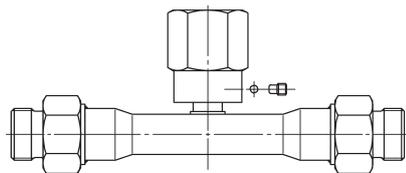
Keine Verbindung des fertigen Systems darf gelöst werden, da ansonsten Füllflüssigkeit austritt und das Druckmesssystem seine Funktionsfähigkeit verliert.
