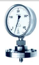
Messflansch: Anzeigebereiche ≤ 250 mbar = Ø 160 mm, Anzeigebereiche ≥ 400 mbar = Ø 100 mm, oberer Messflansch CrNi-Stahl 1.4301
