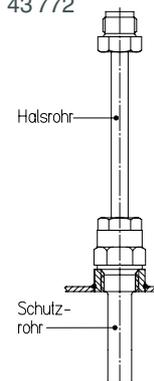
Kombination mit Anschlussverschraubung AV1
