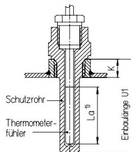
Kombination mit Halsrohr HR für Fühler A3 / B3
